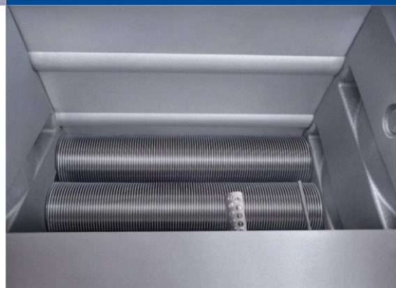
Schimbătorul de căldură cu design de tip monobloc
